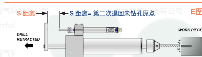
E图：钻孔机第二次钻孔后退后回到未钻孔位置，离合器自锁再煞住稳速器轴心，可以清楚看到E图S的距离越长了，也说明下次的钻孔能更快速和更有效率。
