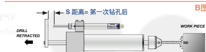
B图：装置PeckChek Controls离合器的自动钻孔机，已钻入加工物后第一次退回回到未钻孔位置，离合器自锁煞住轴心，左图稳速器轴心无法回归到B图的状态。
