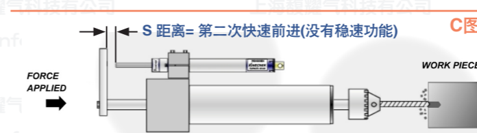
C图：当钻头已经到达A图位置时，可以看到C图磁块都还没有接触到稳速器轴心头，所以B图已被加工物的深度尺寸，是没有控速的，这样第二次再钻孔时就节省时间效率。
